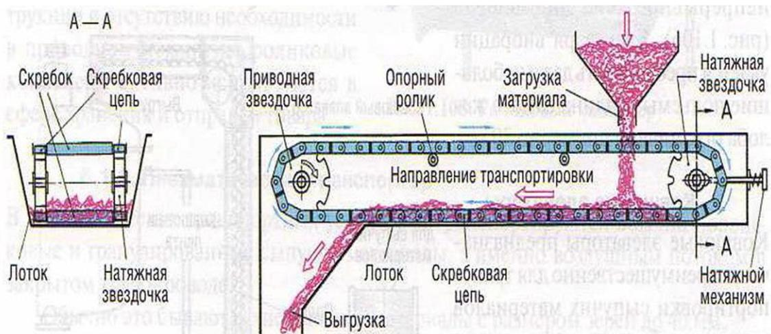
Рис. I.104. Скреповый транспортер
